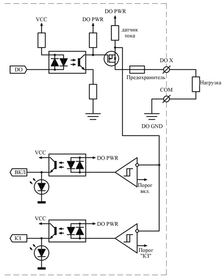
Использование канала DO в качестве выхода типа «сухой контакт»:
