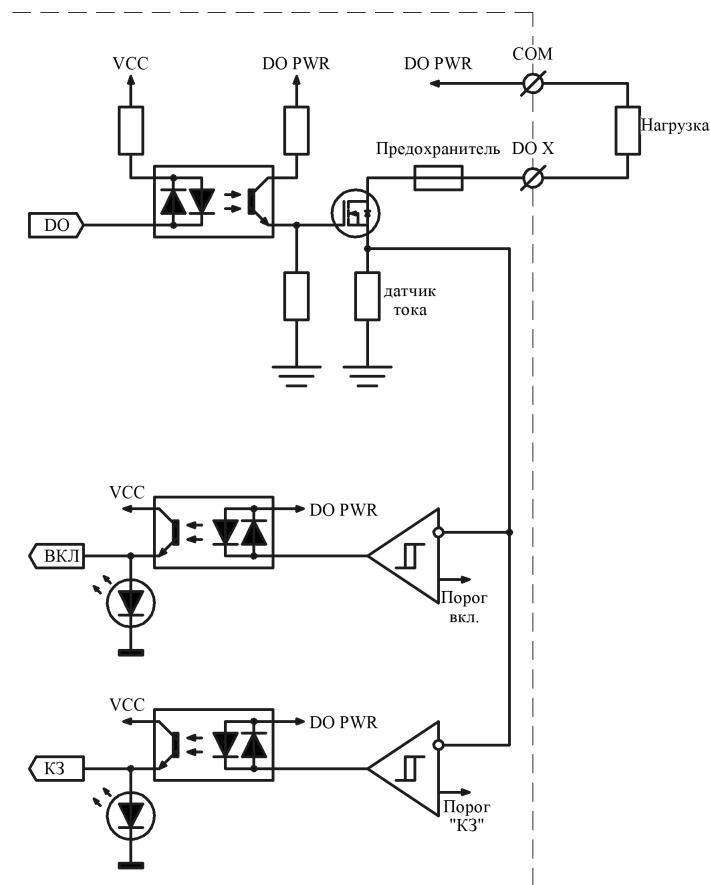
Подключение активной нагрузки Р-канал:
