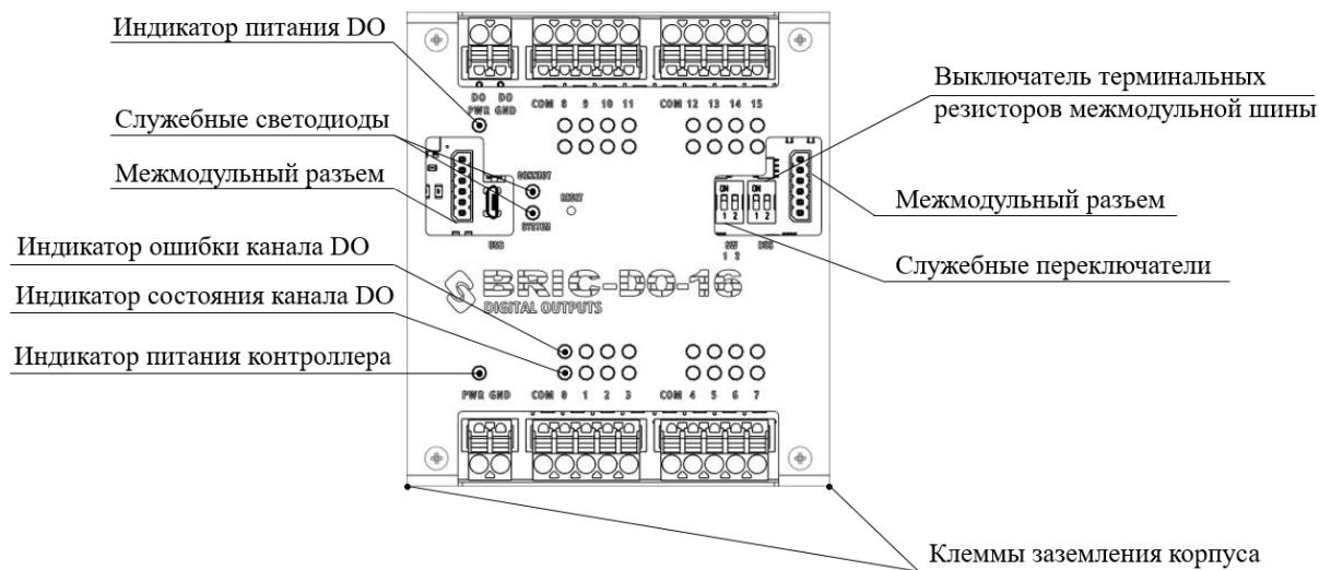
Модуль BRIC-DO-16 выполнен в металлическом корпусе, состоящем из двух частей. Для крепления на DIN-рейку на задней стенке корпуса имеется клипса.
