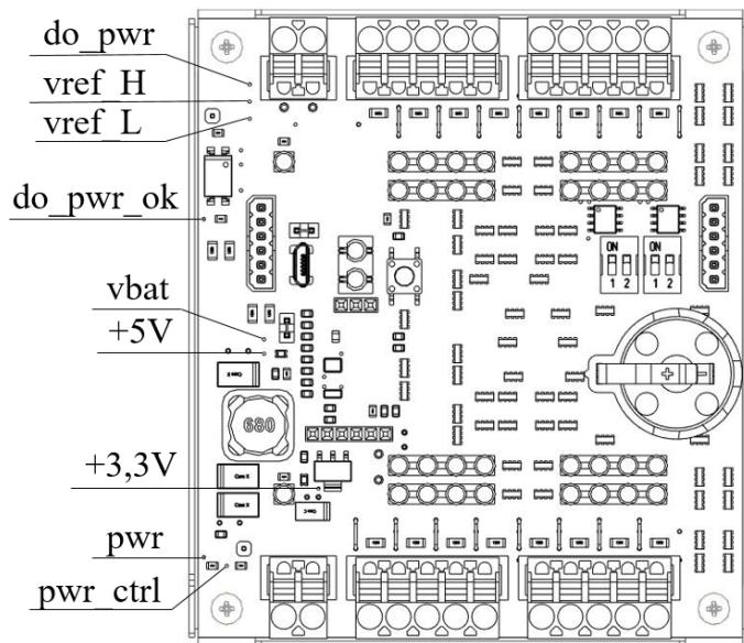
Так как в модуле реализована гальваническая изоляция, контрольные точки необходимо измерять относительно «собственной» гальванически изолированной «земли». Допустимый уровень значений приведен в таблице.
