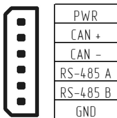
Клеммы PWR и GND на межмодульном разъеме и одноименные клеммы питания модуля соединены напрямую.
